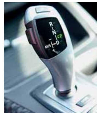
„Steptronic“ heißt das Geheimnis des 6-Gang-Automatik-Getriebes. Die Schaltung ermöglicht schnelle und komfortable Gangwechsel.
